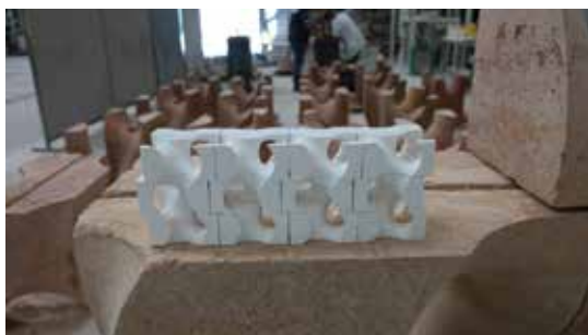
3B yazıcı ile üretilen duvar maketi, 1:1 ölçekli sıkıştırılmış toprak blok denemeleri.
